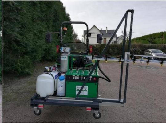
Système de pulvérisation sur châssis 3 points porté avec 15 bouteilles piloté par « Xenius Expérimentation » et rampe latérale de 4 mètres.
