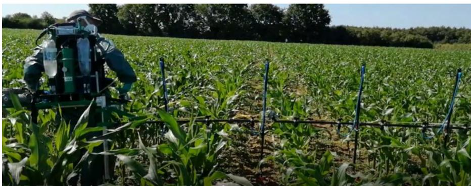
**EXPPEND** : Pendillard Dropleg pour rampe carbone d'expé
